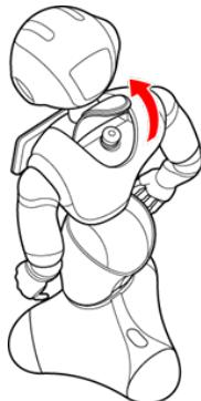
3 緊急停止ボタン（「3-3-1 緊急停止ボタン」32 ページ参照）を軽く右に回し、ボタンが「ポン」と浮くことを確認する
