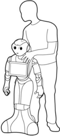
**9** Pepper を目的の場所まで押す**10** Pepper の首の後ろの柔らかいカバーを開けて、緊急停止を解除する（「5-2-4 緊急停止を解除する」52 ページ参照）
