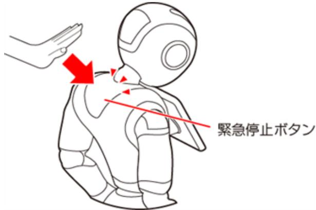
緊急停止ボタンを押すと、Pepper への電気供給がすべて停止して、Pepper の電源を即座に切ることができます。安全を確保するための重要な機能です。緊急停止ボタンの使用方法および解除について詳しくは、51 ページの「5-2-3 緊急停止ボタンを使って電源を切る」、52 ページの「5-2-4 緊急停止を解除する」を参照してください。
