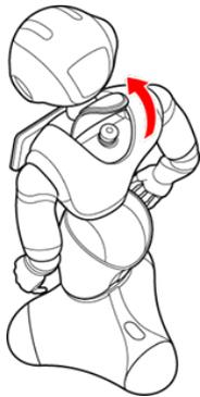
3 緊急停止ボタン（「3-4-2 緊急停止ボタン」31 ページ参照）を軽く右に回し、ボタンが「ポン」と浮くことを確認する
