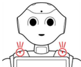
肩の LED ランプは、状態表示と通知以外に、起動/停止時に点灯します。
