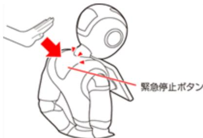
首の後ろにあるゴムカバーの上から、手のひらで緊急停止ボタンを押し（「カチッ」と音がします）、Pepperの電源を切ります。
